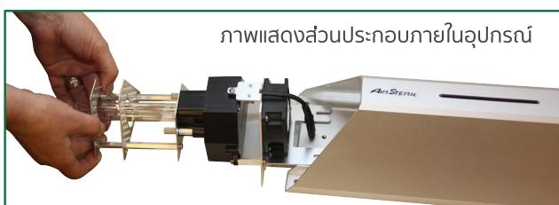
เมื่ออากาศผ่านเข้าตัวเครื่องที่มีหลอดยูวีและตัวเร่งปฏิกิริยาไทเกเนียมไดออกไซด์ ( $TiO_2$ ) เทคโนโลยีภายในจะทำการกำจัดจุลชีพและมลพิษต่างๆ ในขณะที่เทคโนโลยีซึ่งถูกส่งผ่านออกมานา (เช่น ชูปอร์ต์ออกไซด์ไอโอดินและโอโซน) จะช่วยขจัดแบคทีเรียไวรัส เชื้อราน รวมถึงสารประกอบอันตรายระเหยง่าย (VOCs) กันในอากาศและบนพื้นผิวที่เปิดรับ
